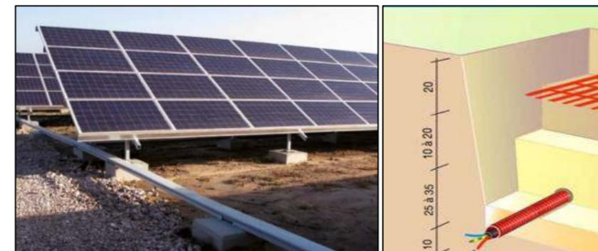
Figure 36 : Exemple de pose de câble sur un chemin de câble DC ou souterrain AC/HTA
