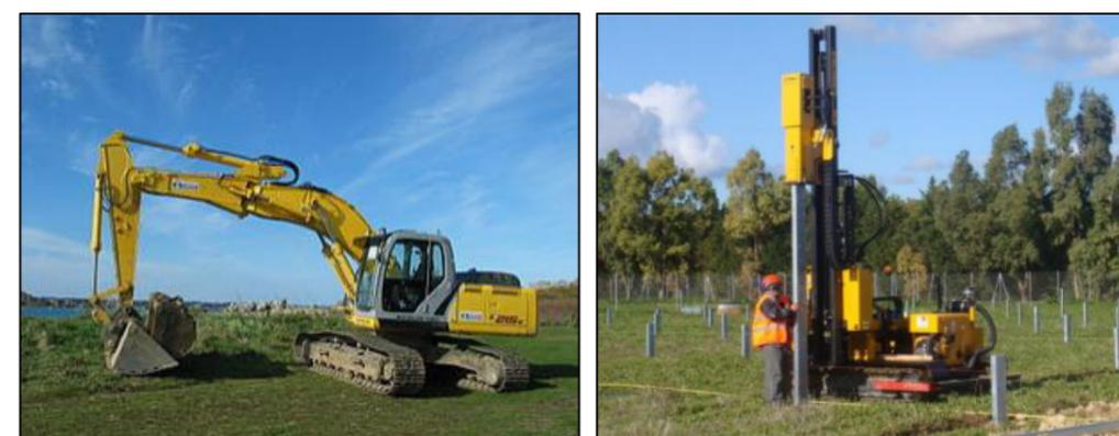
Figure 47 : Exemple d'une pelleteuse et d'une batteuse de pieux
