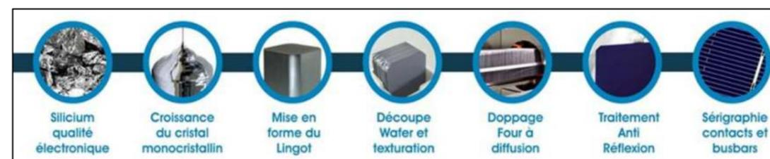
Figure 28 : Procédés de fabrication d'une cellule cristalline semi-conductrice de silicium
